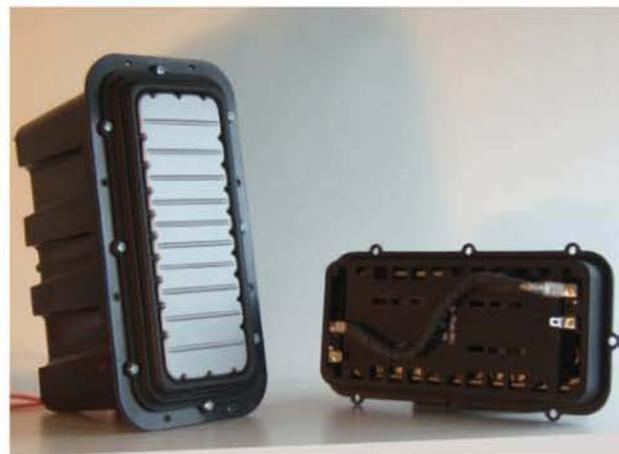
*Questi midrange sono senza dubbio i componenti più interessanti delle Prelude Forty: la membrana è realizzata sempre nello stesso sandwich di alluminio e ceramica, con una forma rettangolare che ne ottimizza la superficie di emissione in rapporto all'ingombro e delle nervature ricavate dallo stampo, in senso laterale, che ne controllano i modi di break-up principali. Il cestello*
